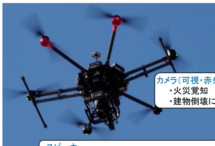
高所AIカメラによる出火や建物倒壊による 道路閉塞等の早期検知
