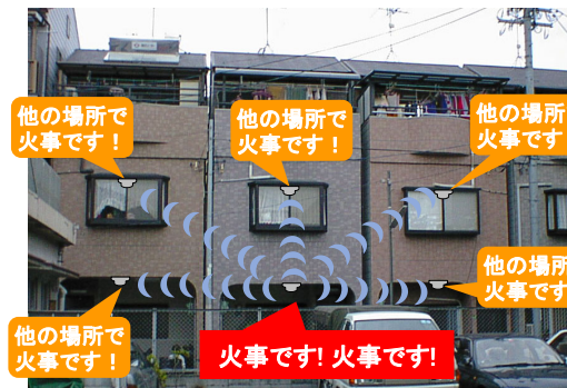
建物間で連動して火災を早期に感知 （連動型火災警報器の設置）
