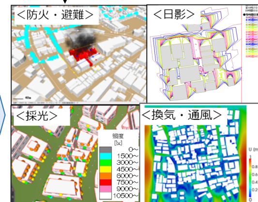
3次元市街地環境性能評価ツールによるシミュレーション
