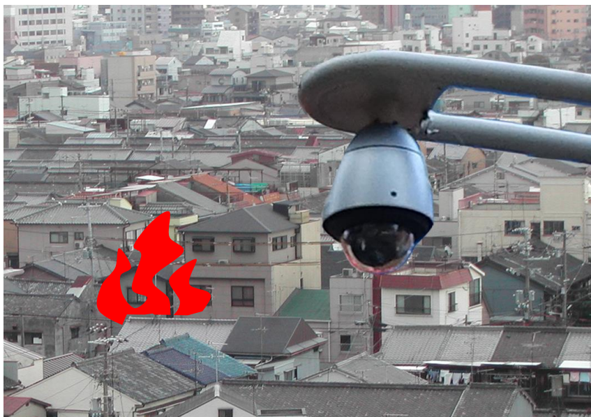
高所AIカメラによる出火や建物倒壊による 道路閉塞等の早期検知
