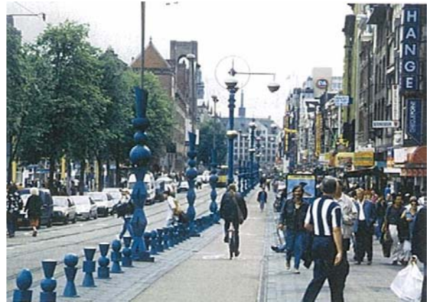
LRT軌道と歩道の間に設けられた自転車道：アムステルダム（蘭）
